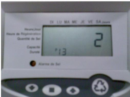
Sur le contrôleur, appuyer pendant 5 secondes sur les flèches Haut et Bas en même temps.
