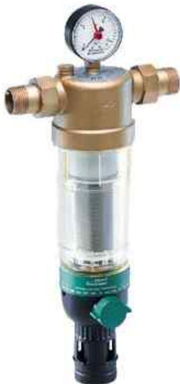
Les filtres à rinçage à contre courant assurent continuellement une alimentation en eau filtrée. La filtration permet d'éviter un encrassement des installations par des particules solides externes (rouille, sable, ...).
